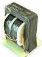
On trouve juste derrière lui plusieurs filtres pour empêcher les parasites hautes fréquences générés par l'étage de découpage (ou d'un PFC actif) de remonter vers le réseau pour le polluer. Sur le schéma, on a 2 filtres T1 et T2 avec les
